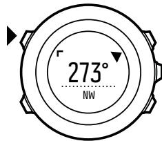
Kompas se po jedné minutě přepne do režimu úspory energie.Tlačítkem [Start Stop] jej znovu aktivujete.
