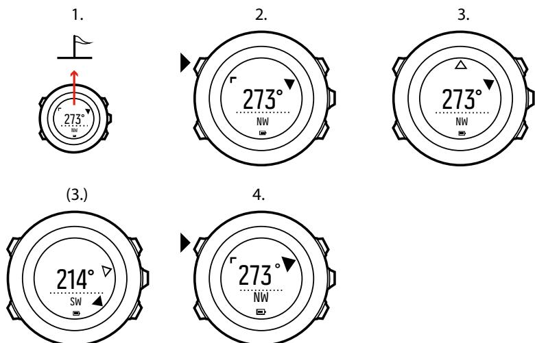
**POZNÁMKA:** Když používáte kompas v režimu cvičení, tlačítko [Back Lap] pouze aretuje azimut a ruší jeho aretaci. Chcete-li změřit mezičas tlačítkem [Back Lap], musíte opustit zobrazení kompasu.
