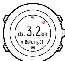
Když se pohybujete ( $> 4 \text{ km/h}$ ), hodinky ukazují směr k POI (nebo waypointu, pokud navigujete po trase) podle GPS.
