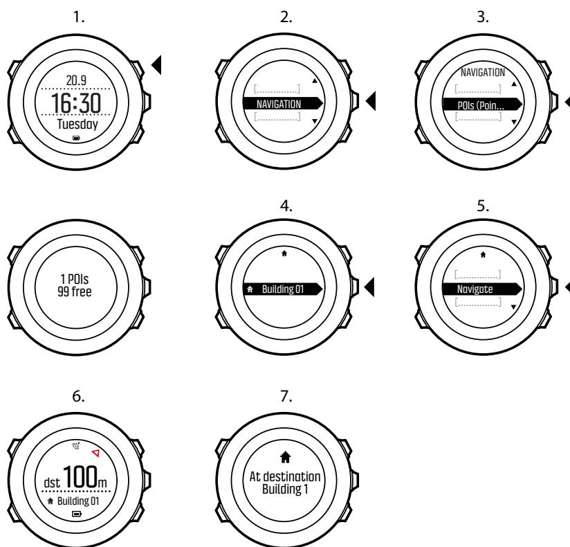
Když stojíte nebo se pohybujete pomalu (< 4 km/h), hodinky ukazují směr k POI (nebo waypointu, pokud navigujete po trase) podle azimutu na kompasu.
