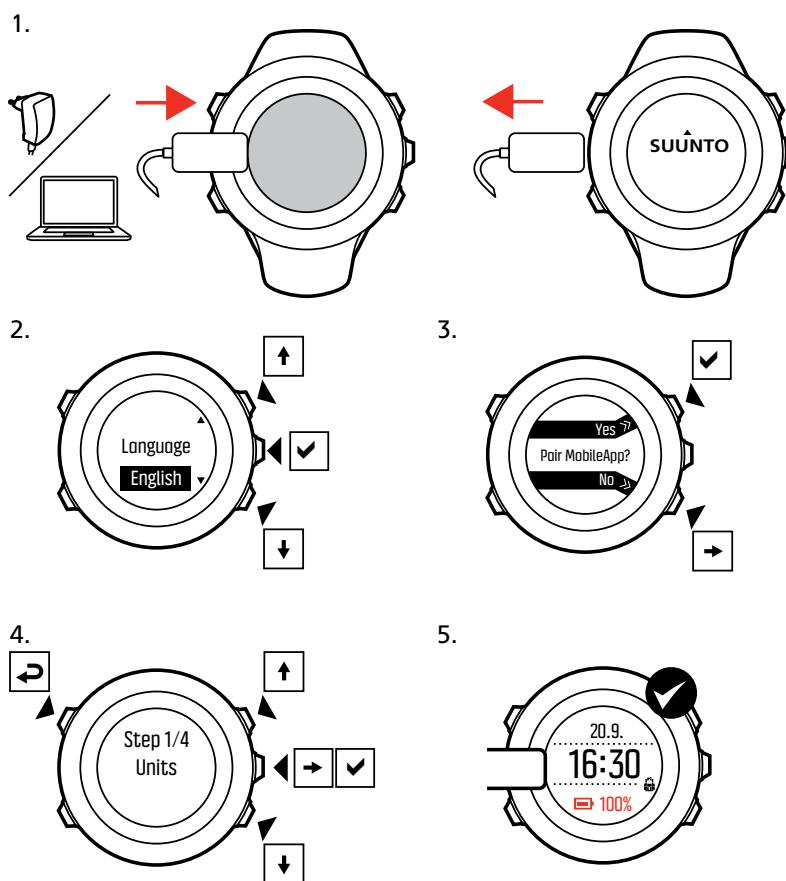
Úplné nabití baterie trvá přibližně 2–3 hodiny. Při připojení kabelu USB k počítači jsou tlačítka uzamčená.
